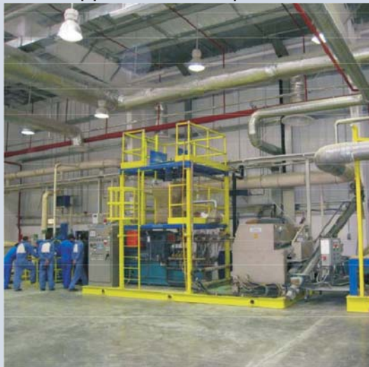
Установка линии по производству антикоррозийных покрытий
